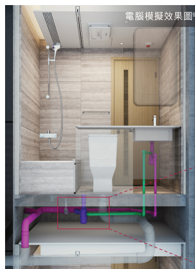
浴室洗手盆及地台去水接駁經特別設計，所有浴室設有地台去水補水導管（綠色喉管）
